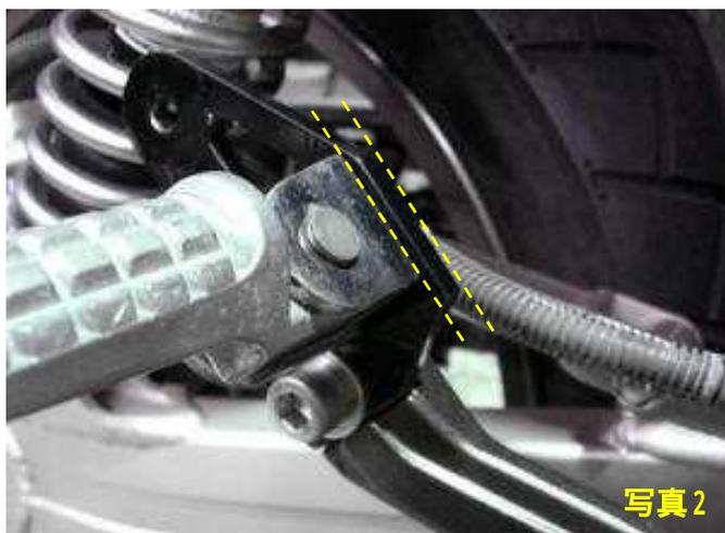
取り外したタンデムステップを で取り付けしたサイレンサースターに取り付けます。
