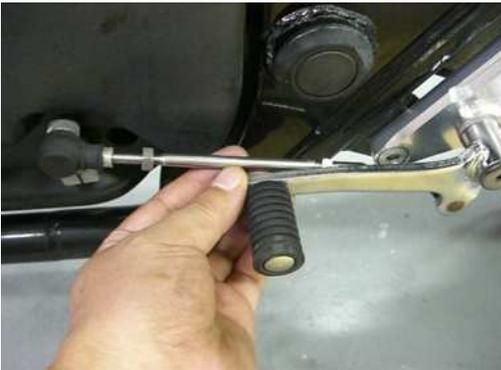
純正のチェンジロッドを取り付けて、高さを調整します。
