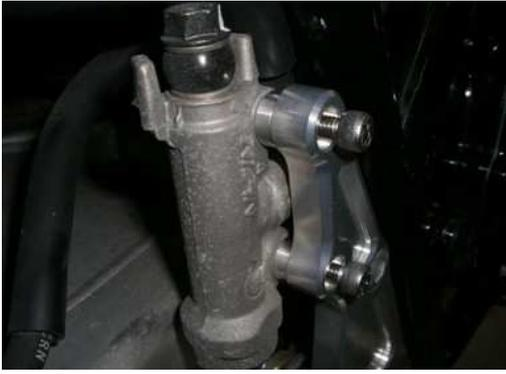
マスターとステッププレート間にオフセットカラーを入れて、付属のM6ボルトで固定します。
