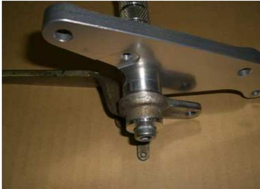
ペダルオフセットカラーをブレーキペダルとステッププレートの間に入れ、アクスルカラーをペダルに入れて、付属のM8ボルトで取り付けます。
