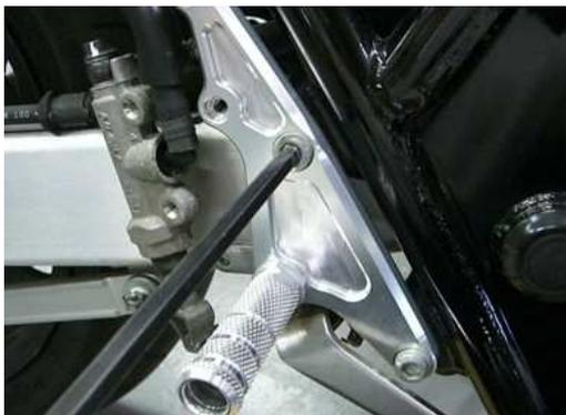
車体に純正のボルトを使って取り付けます。
