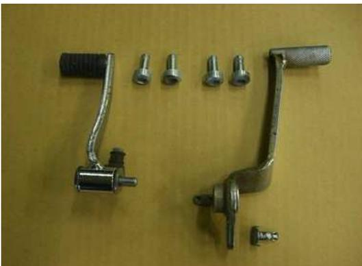
純正のブレーキペダル、チェンジペダル、取付けボルト
