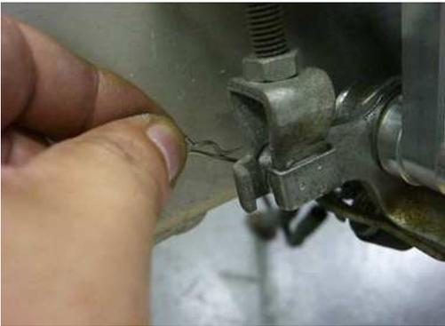
プッシュロッドピンを最後まで差し込んだら、付属のRピンをプッシュロッドピンに差込み、固定します。
