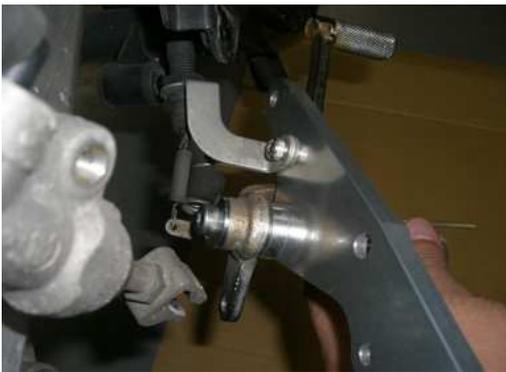
ステップバー、ブレーキペダルを取り付けた後、車体側に残っているブレーキスイッチを付属のM6×10のボルトでステッププレートに取り付けます。
