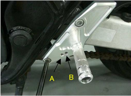
ステップバーを付属のM8×40ボルトで確実に固定し。
